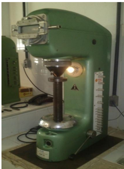
Figura 26 – Ensaio de dureza Vickers. a) Durômetro Vickers. b) ilustração esquemática da impressão obtida e as diagonais analisadas.
