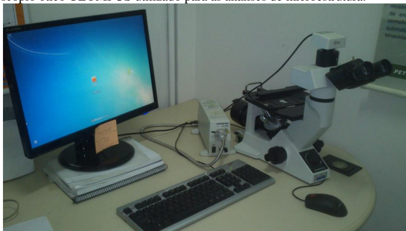
Figura 25 - Microscópio ótico OLYMPUS utilizado para as análises de microestrutura.
