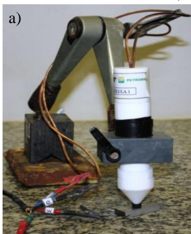
Figura 28 – Ensaio de EPR-DL. a) célula montada para o ensaio. b) Conjunto célula e sensor. (RELATÓRIO TÉCNICO UFC-PETROBRAS, 2007).
