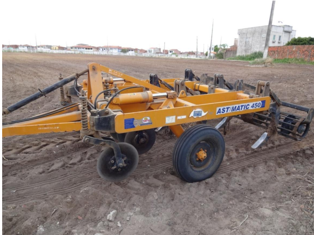
Figura 7 – Vista lateral do subsolador marca MARCHESAN AST/MATIC 450 utilizado
