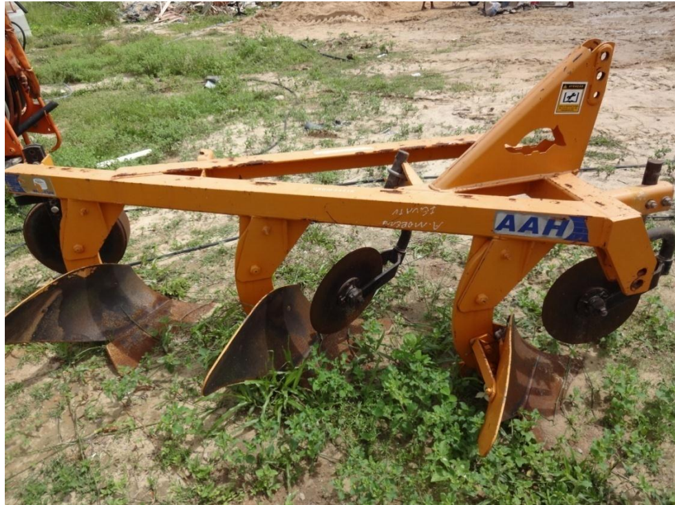
Figura 8 – Vista lateral do arado de aiveca helicoidal marca MARCHESAN AAH utilizado
