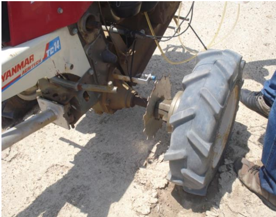
Figura 8 – Sensor indutivo instalado na roda do microtrator
