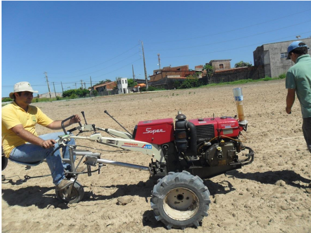
Figura 7 – Microtrator Yanmar NSB 14S, instrumentado
