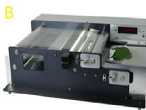
Figura 11. Equipamentos utilizados para a quantificação dos depósitos e perdas no experimento (A) Espectrofotômetro (B) Medidor de superfície
