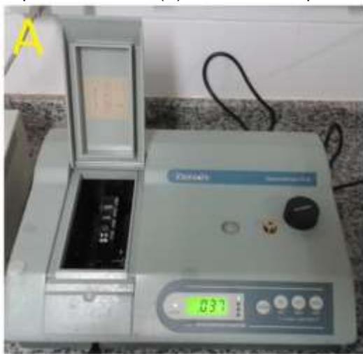
Figura 11. Equipamentos utilizados para a quantificação dos depósitos e perdas no experimento (A) Espectrofotômetro (B) Medidor de superfície
