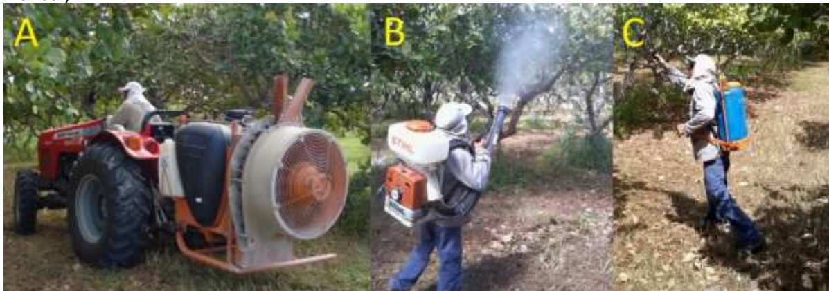
Figura 1. Equipamentos de aplicação de defensivos utilizados na Extração Experimental da Embrapa em Pacajús (A - Turboatomizador, B - Pulverizador Costal Motorizado, C - Pulverizador Costal Manual)
