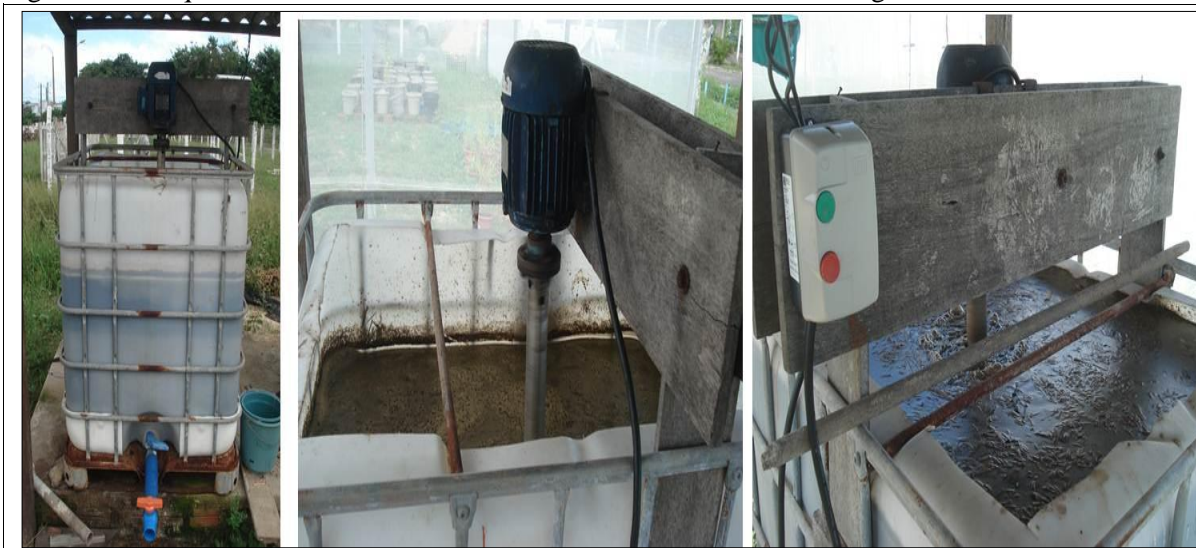
Figura 7 – Tanque de biofertilizante com revolvimento através de centrífuga elétrica
