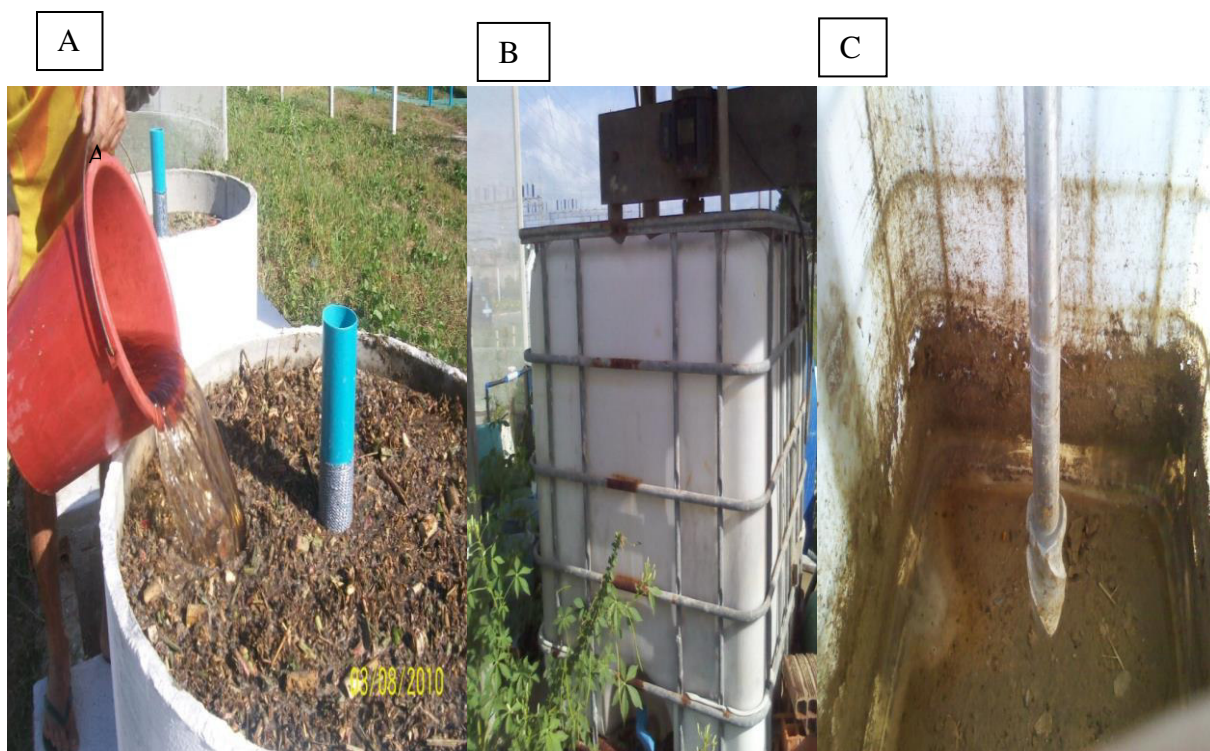
Figura 9 – Tanque de solubilização aeróbica de (A), com capacidade de 706 L (B) e centrífuga de aço (C) acionada eletricamente
