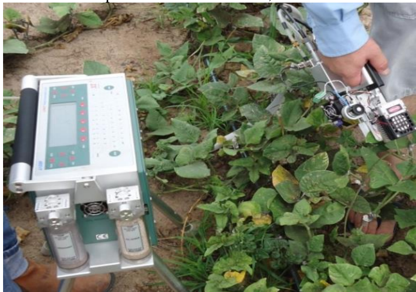
Figura 7 – Medições de fotossíntese (A), transpiração (E) e condutância estomática ( g_s ) com o analisador de gases infravermelho portátil (IRGA), modelo Li – 6400XT utilizado no experimento. Fortaleza-CE, 2012
