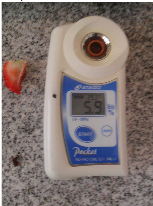
Figura 14 – Refratômetro digital para medição dos sólidos solúveis
