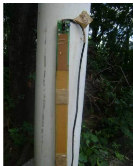
Figura 30 – Capacitor de nível de água com placas planas
