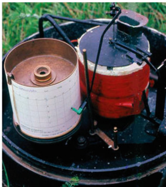
Figura 46 – Estrutura do pluviômetro mecânico.
