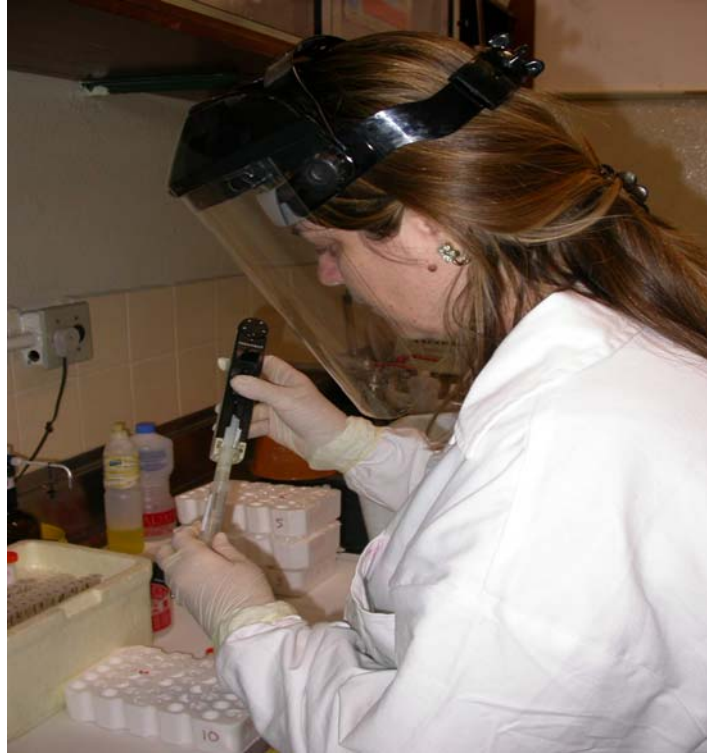
ILUSTRAÇÃO 9: Radioimunoensaio - procedimento para adição da prostaglandina triciada - (H)^3 PGE 2 .
