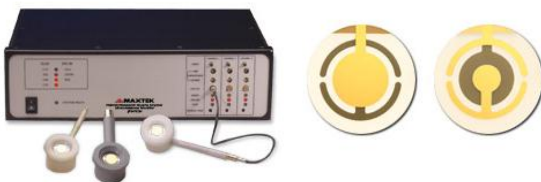
Figura 3.1 – Freqüencímetro (PM-740, Maxtek) e eletrodos comerciais com ouro depositado sobre cristais piezoelétricos.
