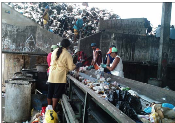
Figura 23 - Segregação de Recicláveis na Usina de Triagem. Fonte: Santos (2007).
