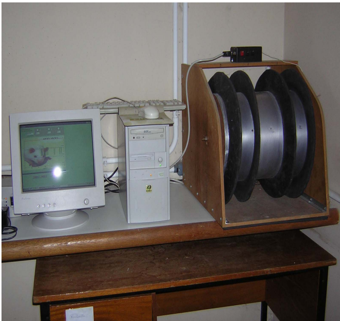
Figura: 3- Sistema utilizado para medir a incapacitação articular (IA) dos animais submetidos à artrite induzida por zymosan (Azy).
