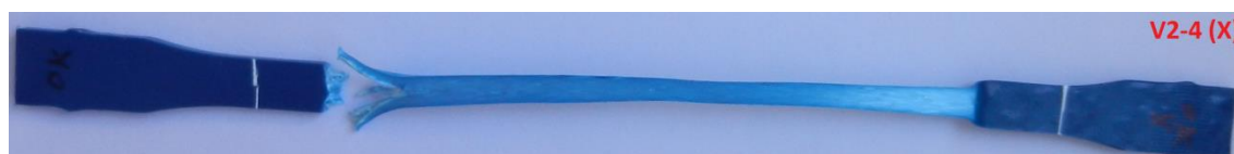
Figura C.1.11 – Foto do C.P. Virgem V2-4 (X), com ataque químico.
