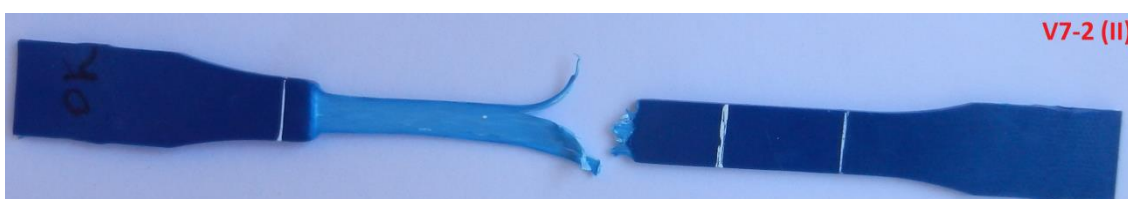
Figura C.1.17 – Foto do C.P. Virgem V7-2 (II), com ataque químico.
