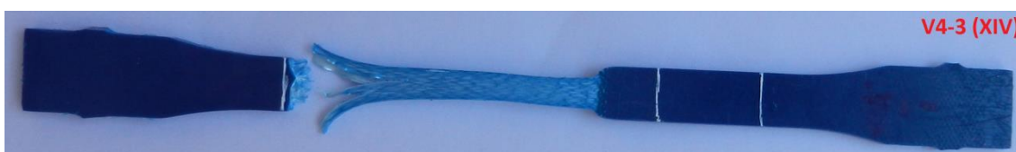
Figura C.1.14 – Foto do C.P. Virgem V4-3 (XIV), com ataque químico.
