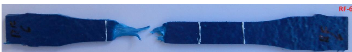
Figura C.2.7 – Foto do C.P. Reciclado RF-6, sem ataque químico.
