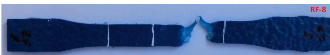
Figura C.2.9 – Foto do C.P. Reciclado RF-8, sem ataque químico.
