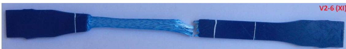
Figura C.1.12 – Foto do C.P. Virgem V2-6 (XI), com ataque químico.
