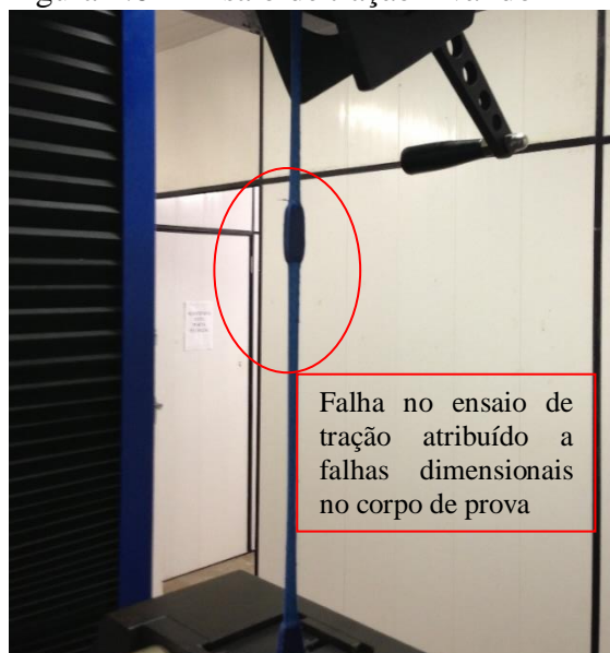
Figura 4.6 – Ensaio de tração inválido
