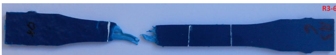
Figura C.2.3 – Foto do C.P. Reciclado R3-6, sem ataque químico.
