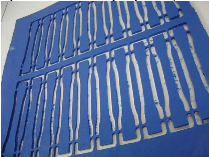
Figura 3.27 – Placa de PE com corpos de prova de tração
