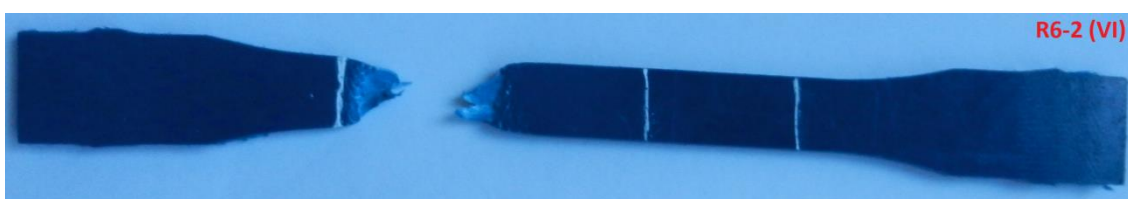
Figura C.2.17 – Foto do C.P. Reciclado R6-2 (VI), com ataque químico.
