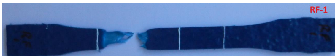
Figura C.2.4 – Foto do C.P. Reciclado RF-1, sem ataque químico.
