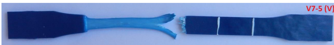
Figura C.1.19 – Foto do C.P. Virgem V7-5 (V), com ataque químico.
