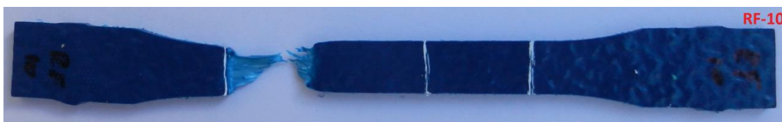
Figura C.2.11 – Foto do C.P. Reciclado RF-10, sem ataque químico.
