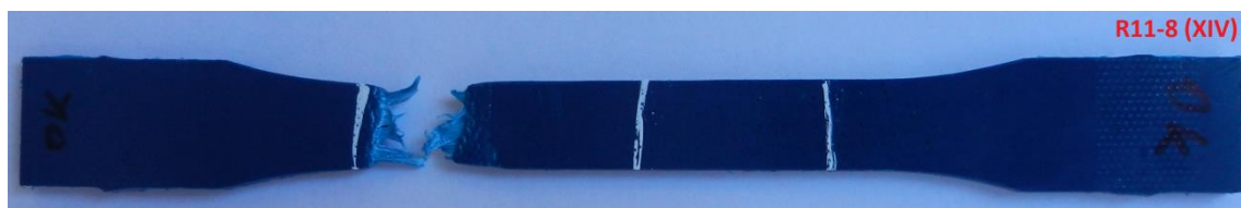
Figura C.2.21 – Foto do C.P. Reciclado R11-8 (XIV), com ataque químico.
