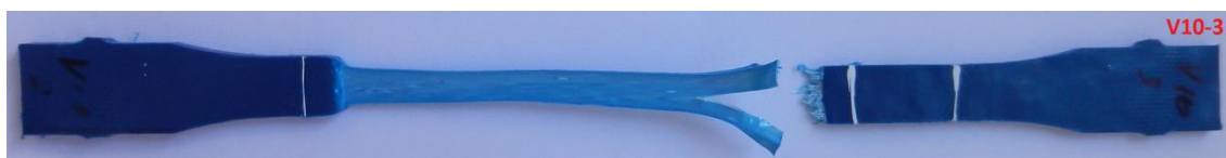
Figura C.1.1 – Foto do C.P. Virgem V10-3, sem ataque químico.
