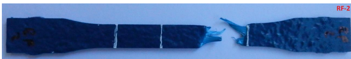
Figura C.2.5 – Foto do C.P. Reciclado RF-2, sem ataque químico.
