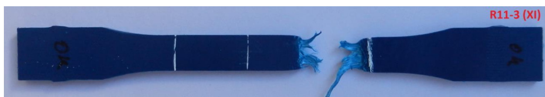
Figura C.2.20 – Foto do C.P. Reciclado R11-3 (XI), com ataque químico.
