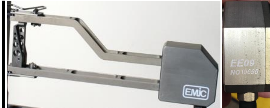
Figura 3.46 – Extensômetro utilizado, EMIC® modelo EE09
