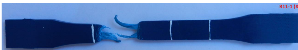
Figura C.2.19 – Foto do C.P. Reciclado R11-1 (X), com ataque químico.
