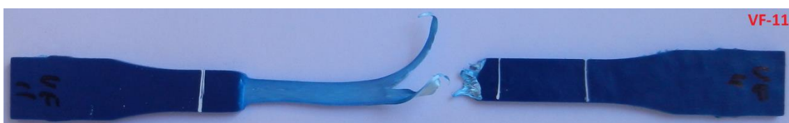
Figura C.1.4 – Foto do C.P. Virgem VF-11, sem ataque químico.
