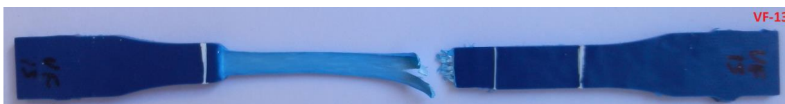
Figura C.1.6 – Foto do C.P. Virgem VF-13, sem ataque químico.
