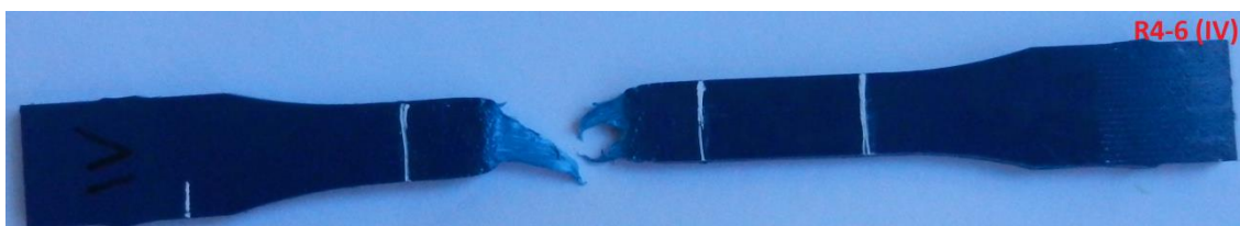
Figura C.2.16 – Foto do C.P. Reciclado R4-6 (IV), com ataque químico.
