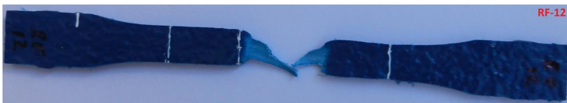
Figura C.2.12 – Foto do C.P. Reciclado RF-12, sem ataque químico.
