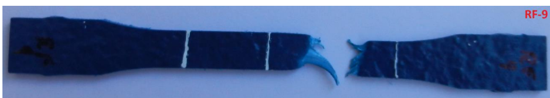
Figura C.2.10 – Foto do C.P. Reciclado RF-9, sem ataque químico.
