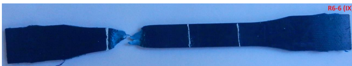
Figura C.2.18 – Foto do C.P. Reciclado R6-6 (IX), com ataque químico.
