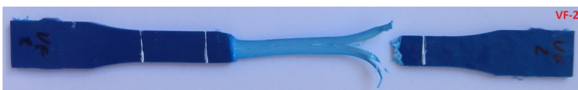
Figura C.1.3 – Foto do C.P. Virgem VF-2, sem ataque químico.
