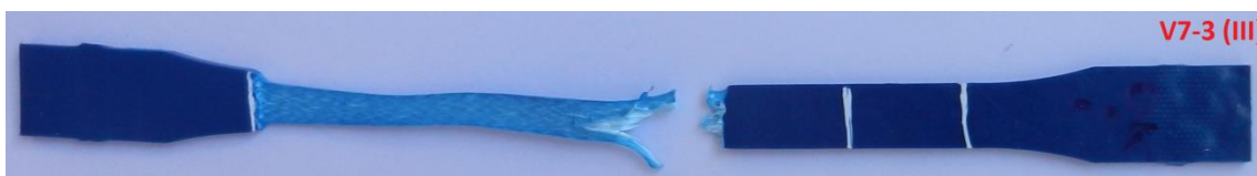
Figura C.1.18 – Foto do C.P. Virgem V7-3 (III), com ataque químico.
