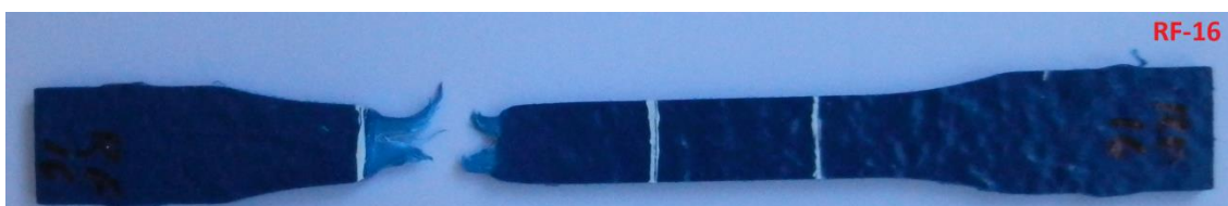
Figura C.2.13 – Foto do C.P. Reciclado RF-16, sem ataque químico.
