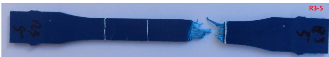
Figura C.2.2 – Foto do C.P. Reciclado R3-5, sem ataque químico.
