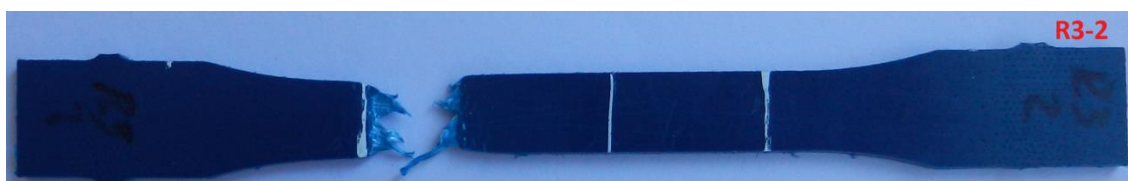
Figura C.2.1 – Foto do C.P. Reciclado R3-2, sem ataque químico.
