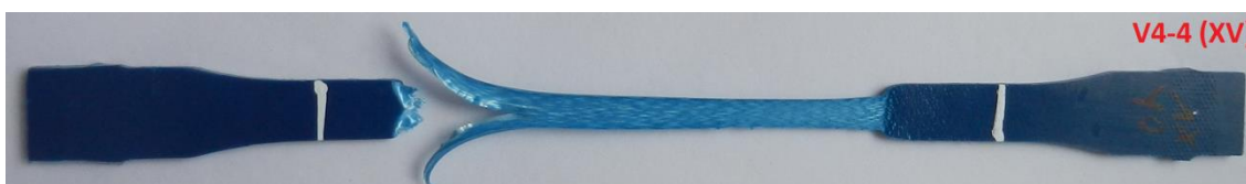
Figura C.1.15 – Foto do C.P. Virgem V4-4 (XV), com ataque químico.
