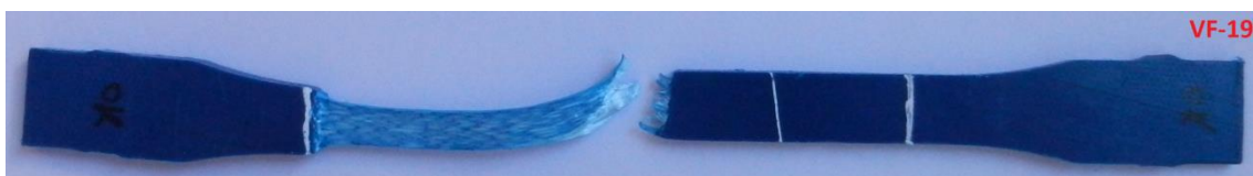
Figura C.1.9 – Foto do C.P. Virgem VF-19, sem ataque químico.
