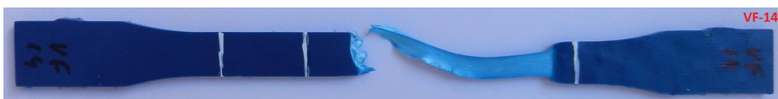
Figura C.1.7 – Foto do C.P. Virgem VF-14, sem ataque químico.
