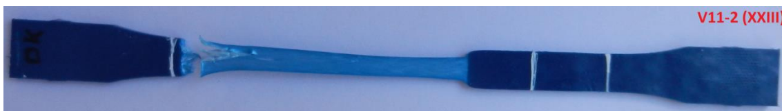
Figura C.1.20 – Foto do C.P. Virgem V11-2 (XXIII), com ataque químico.
