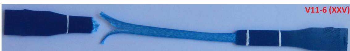
Figura C.1.22 – Foto do C.P. Virgem V11-6 (XXV), com ataque químico.
