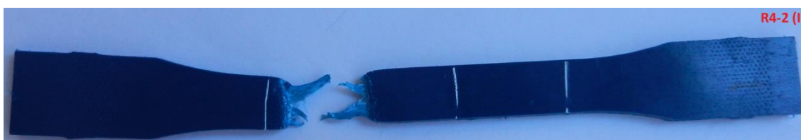
Figura C.2.14 – Foto do C.P. Reciclado R4-2 (I), com ataque químico.
