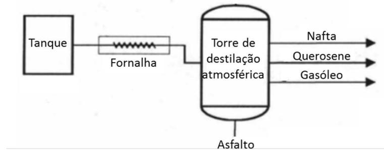
Figura 2: Esquema de destilação de petróleos pesados. Adaptado de [21].
