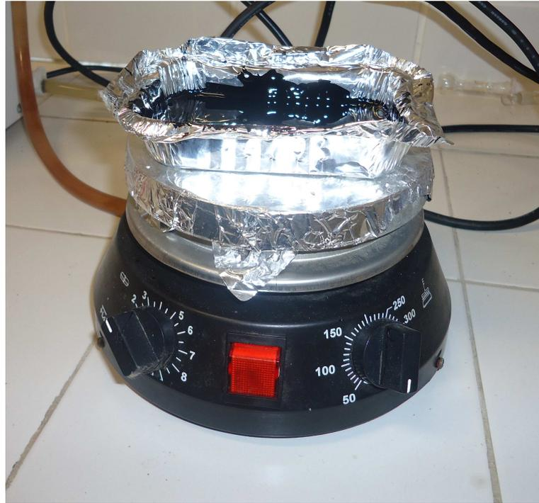
Figura 32: As amostras foram aquecidas para a homogeneização e evitar a separação de fases devido à não estabilidade total a estocagem do CAP.
