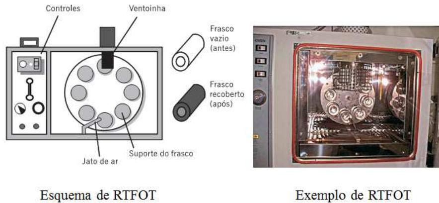
Figura 10: Esquema e exemplo de RTFOT (*Rolling Thin Film Oven Test*). [16].
