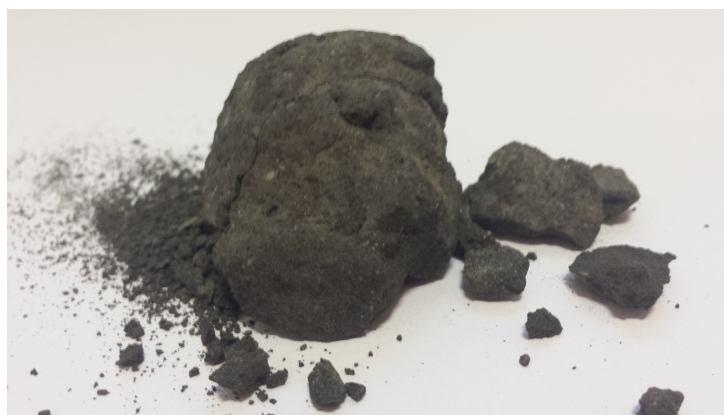
Figura 1.1: Fotografia do material clínquer e pequenos fragmentos gerados através da sua cominuição.
