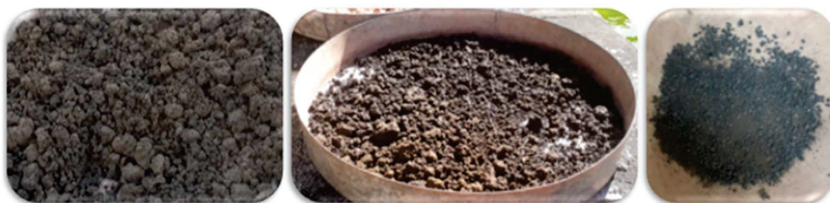
Figura 6 – Etapas de secagem até a formação dos grumos cimentícios
