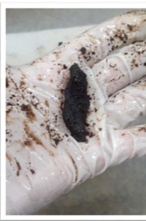
b) tentativa de moldar o cilindro do ensaio de limite plasticidade
