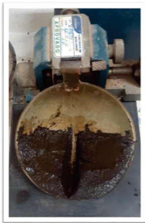
c) tentativa de fechar a ranhura no ensaio de limite de liquidez
