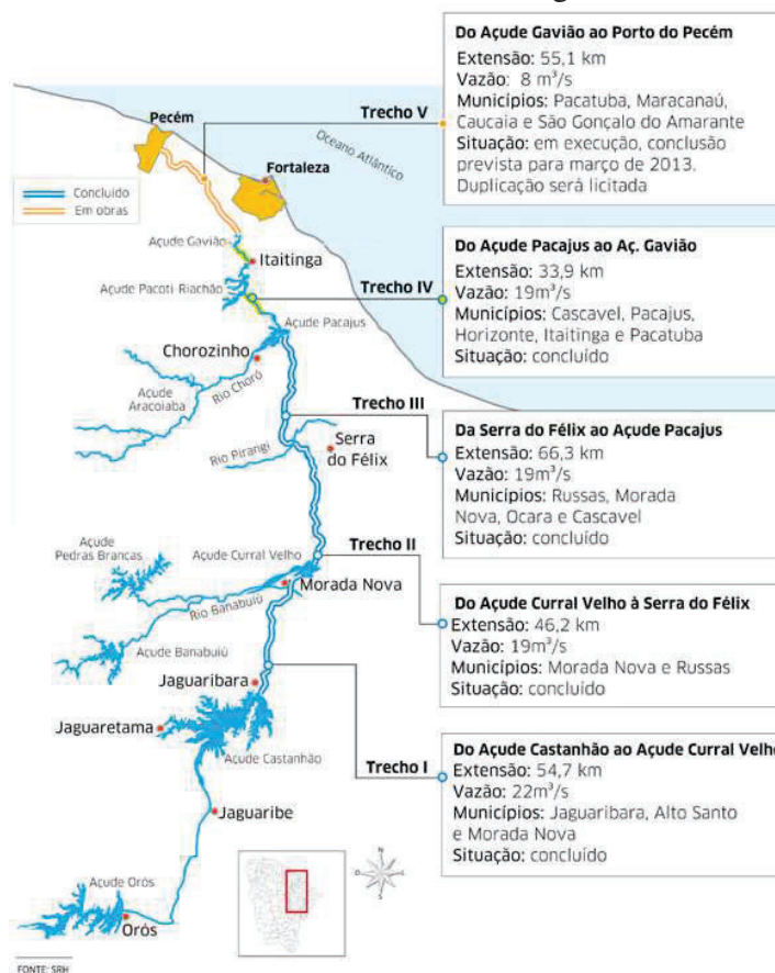
Figura 2 - Sistema de Abastecimento de Água da RMF
