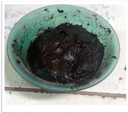
a) brilho na preparação da amostra indica a falta de afinidade do lodo com a água
