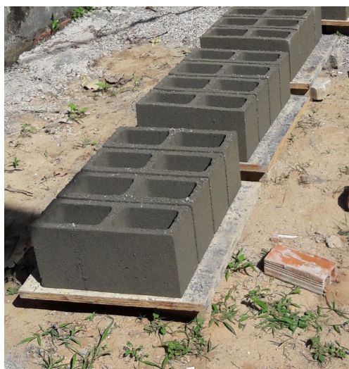
Figura 7 – Blocos após processos de moldagem e extrusão
