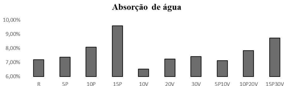
Figura 36 – Representação gráfica dos resultados do ensaio de absorção de água dos blocos
