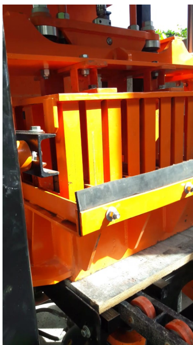
Figura 9 – Processo de vibro-prensagem dos blocos
