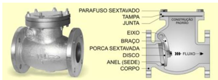
Figura 24 – Válvula de Retenção tipo Portinhola
