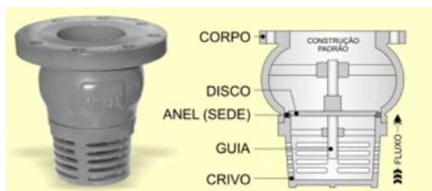
Figura 25 – Válvula de Retenção tipo Fundo de Poço
