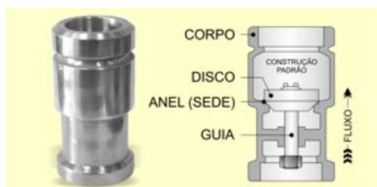
Figura 23 – Válvula de Retenção Vertical
