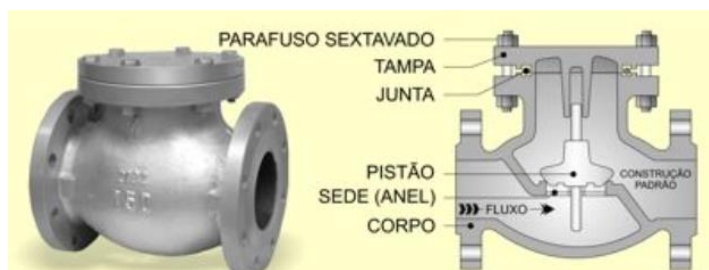
Figura 22 – Válvula de Retenção Horizontal
