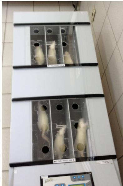
O equipamento utilizado foi uma esteira motorizada própria para ratos *EP 131 Insight®* (Fig. 2) com 6 baias isoladas cada uma com 170mm de altura, largura 97mm e comprimento 385 mm, grade no fundo que produz choque para estímulo das cobaias de até
