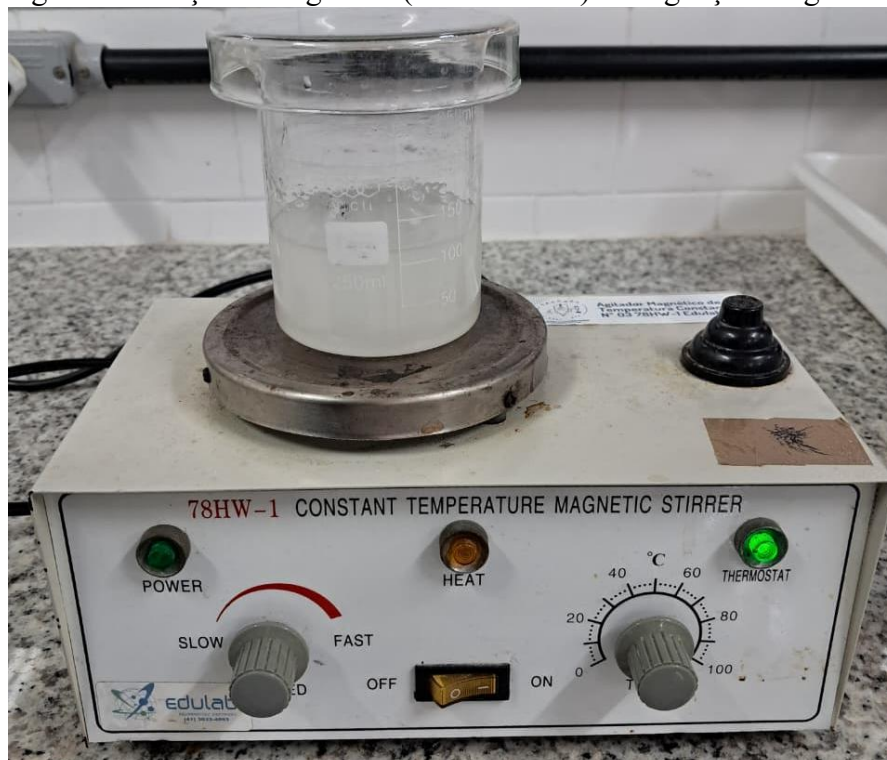
Figura 5. Solução filmogênica (75GM25AM) sob agitação magnética.
