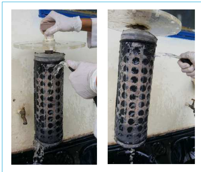
Figura 7 - Limpeza física da membrana dinâmica com água potável.
