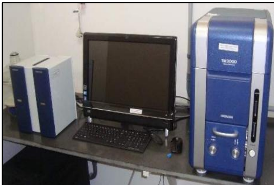
Figura 15 - Microscópio eletrônico de varredura com detector de EDS.
