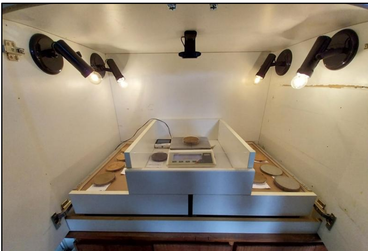
Figura 23 - Vista geral da câmara experimental, mostrando o sistema de iluminação, a câmera, a balança e o termo-higrômetro
