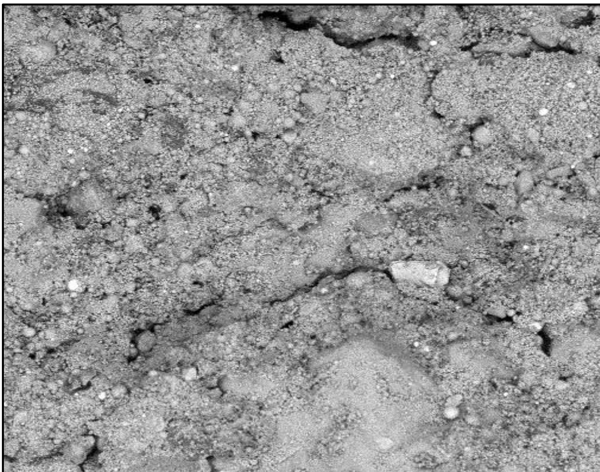
Figura 31 - Micrografia da matriz 80S20C aumentada x100.
