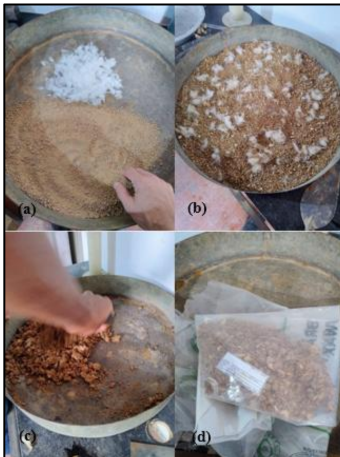
Figura 13 - Procedimentos de Mistura solo-fibra: (a) separação da quantidade de solo seco e fibra e homogeneização; (b) adição gradual de fibras; (c) adição de água e revolvimento; (d) armazenamento para uniformização do teor de umidade
