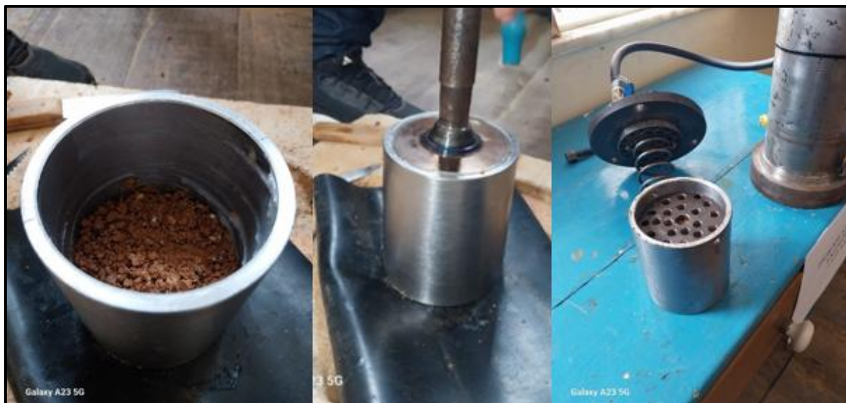
Figura 21 - Moldagem dos corpos-de-prova em cilindro metálico.
