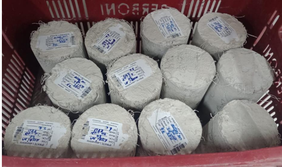
Figura 16- Corpos de prova utilizados para os ensaios de módulo de elasticidade
