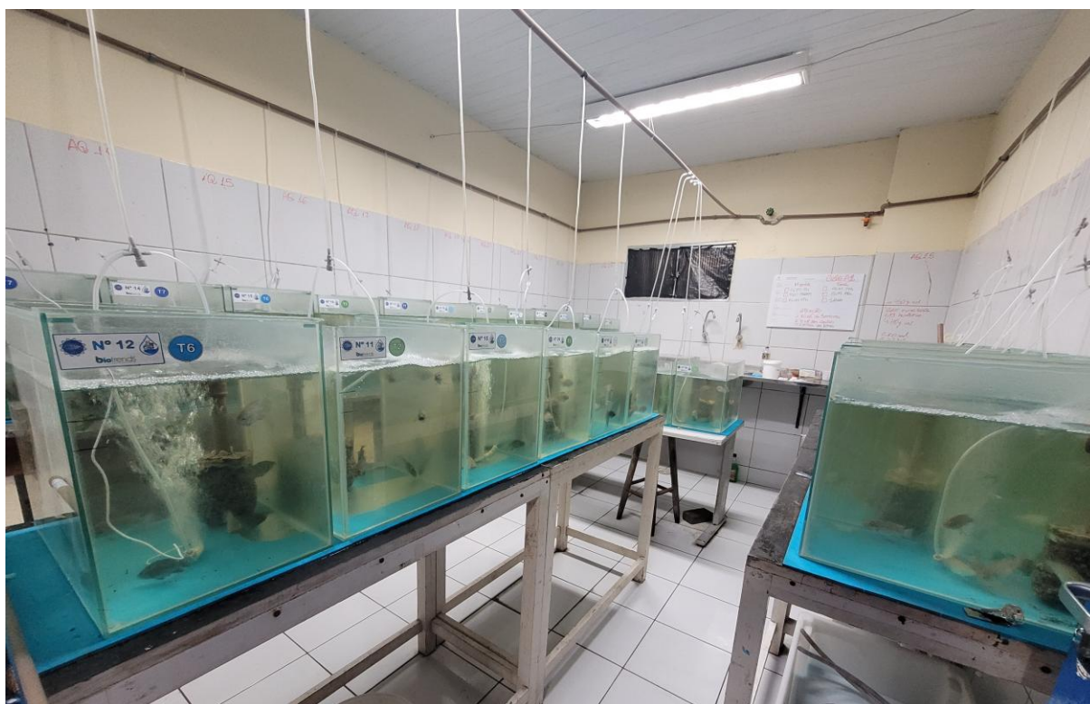
Figura 5 – Sistema experimental composto por aquários de 40 L utilizados no ensaio de crescimento de juvenis de tilápia-do-Nilo ( Oreochromis niloticus ).
