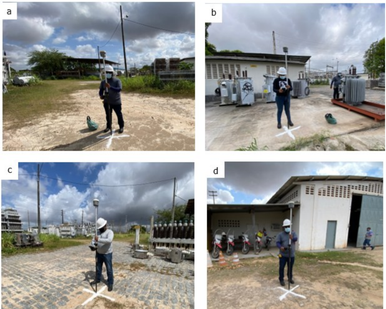
Figura 8 - Registro e marcação dos pontos de controle e checagem no campo
