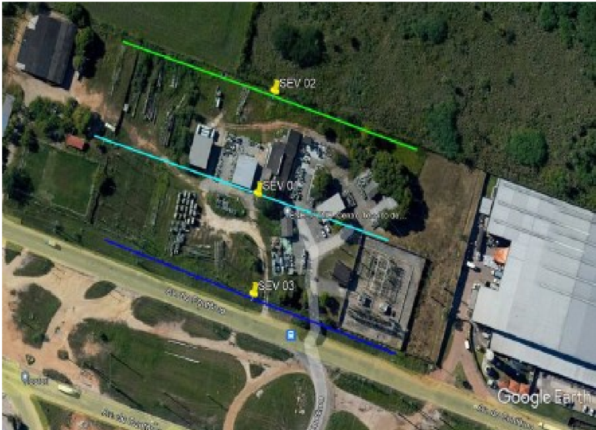
Figura 16 – Configuração do imageamento elétrico utilizando o arranjo Dipolo-Dipolo
