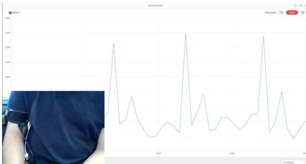
Figura 5 – Aquisição do sinal de ECG sem aplicação de filtragem digital, obtida diretamente do ADC do microcontrolador durante ensaio experimental em repouso. No canto inferior esquerdo, observa-se o protótipo vestível posicionado no usuário durante a aquisição.
