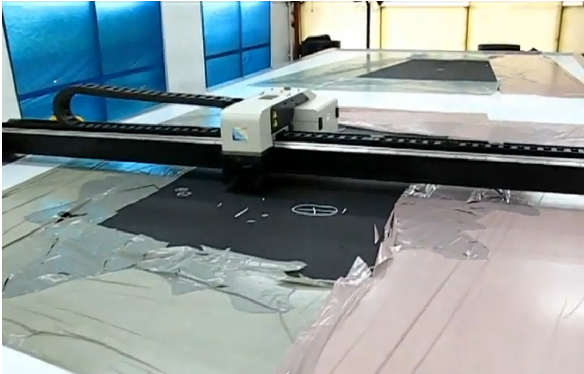
Figura 7 - Processo de corte usando a Gerber Taurus XD
