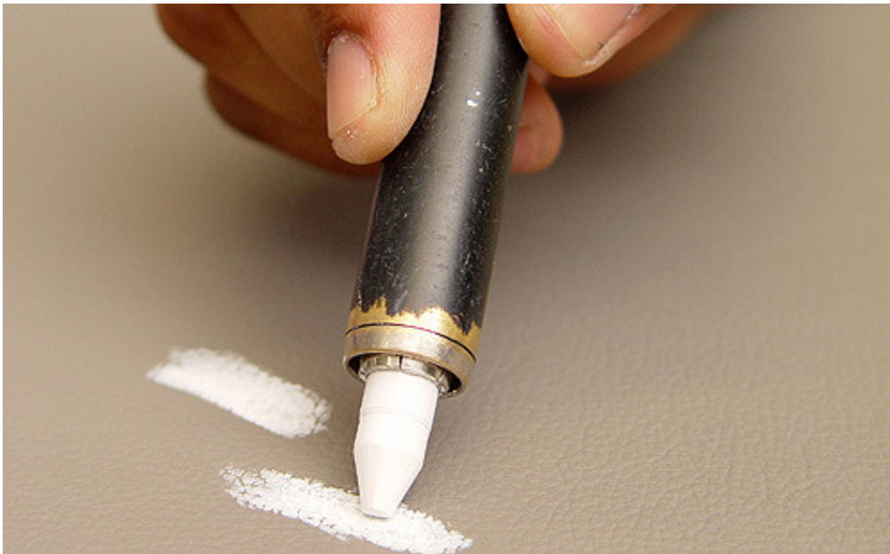
Figura 5 - Processo de marcação de imperfeições na pele
