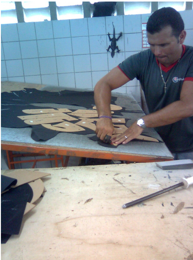
Figura 6 - Processo manual de corte de couro
