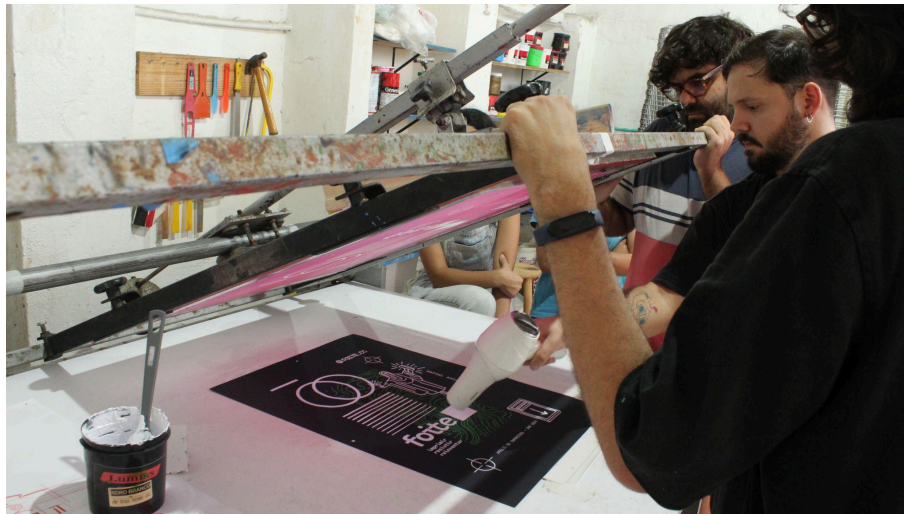
Figura 22 – Processo de secagem da primeira passagem de tinta branca com secador elétrico para, em seguida, passar mais uma camada com o objetivo de deixar o branco mais opaco
