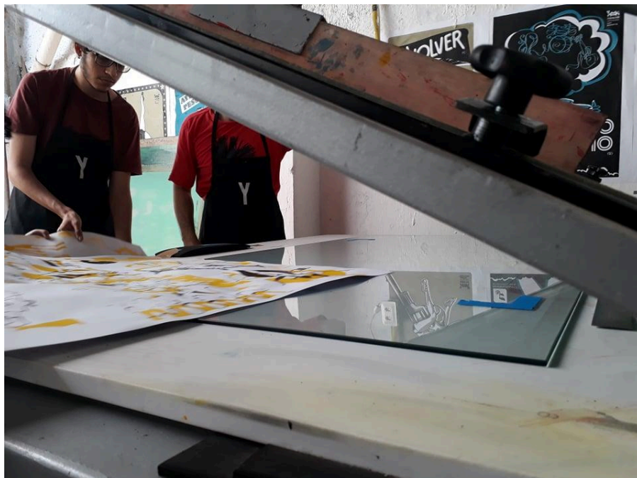
Figura 1 – Impressão em serigrafia de parte da revista experimental “ACASO”, que também incluiu risografia, letterpress e encadernação artesanal dentre as técnicas utilizadas
