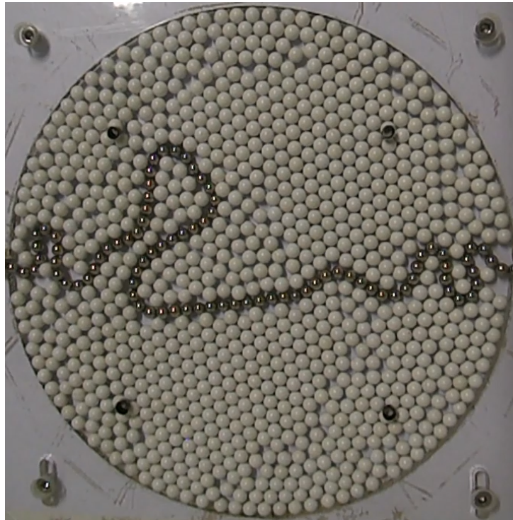
Figura 12 – Configuração experimental de empacotamento em regime de saturação ( \eta = 0.83 )
