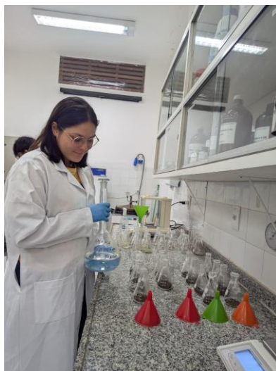
Figura 3- Extração de Cádmiio das amostras de solo e parte vegetal
