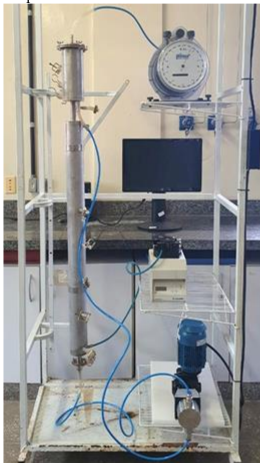
Figura 6 – Configuração experimental do RALF utilizada.
