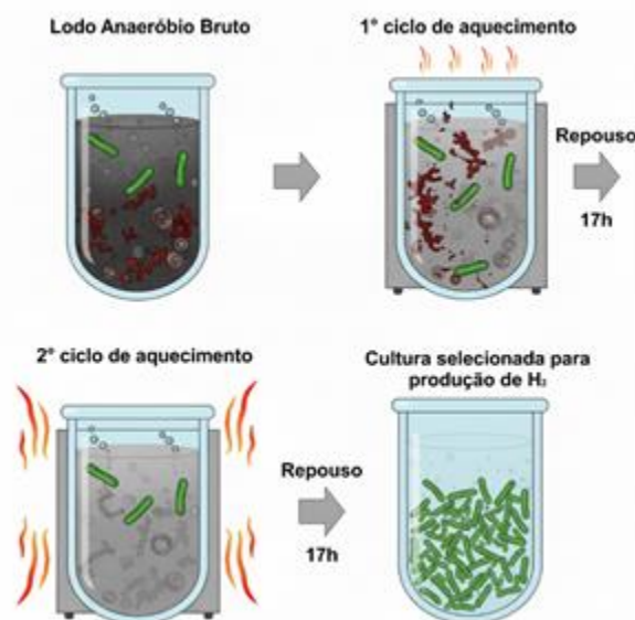
Figura 4 – Pré-tratamento por choque térmico.
