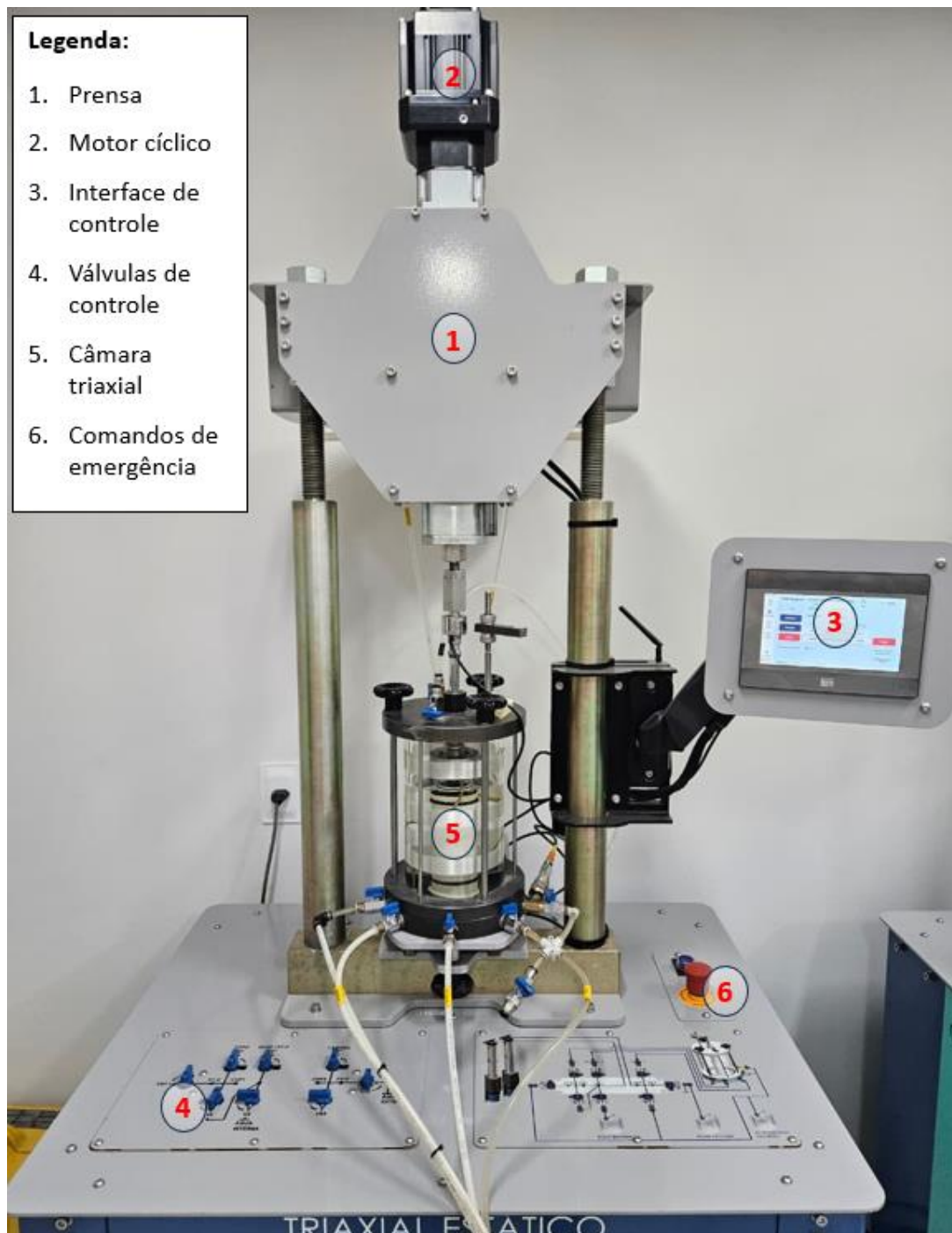
Figura 37 – Equipamento triaxial cíclico utilizado nesse estudo
