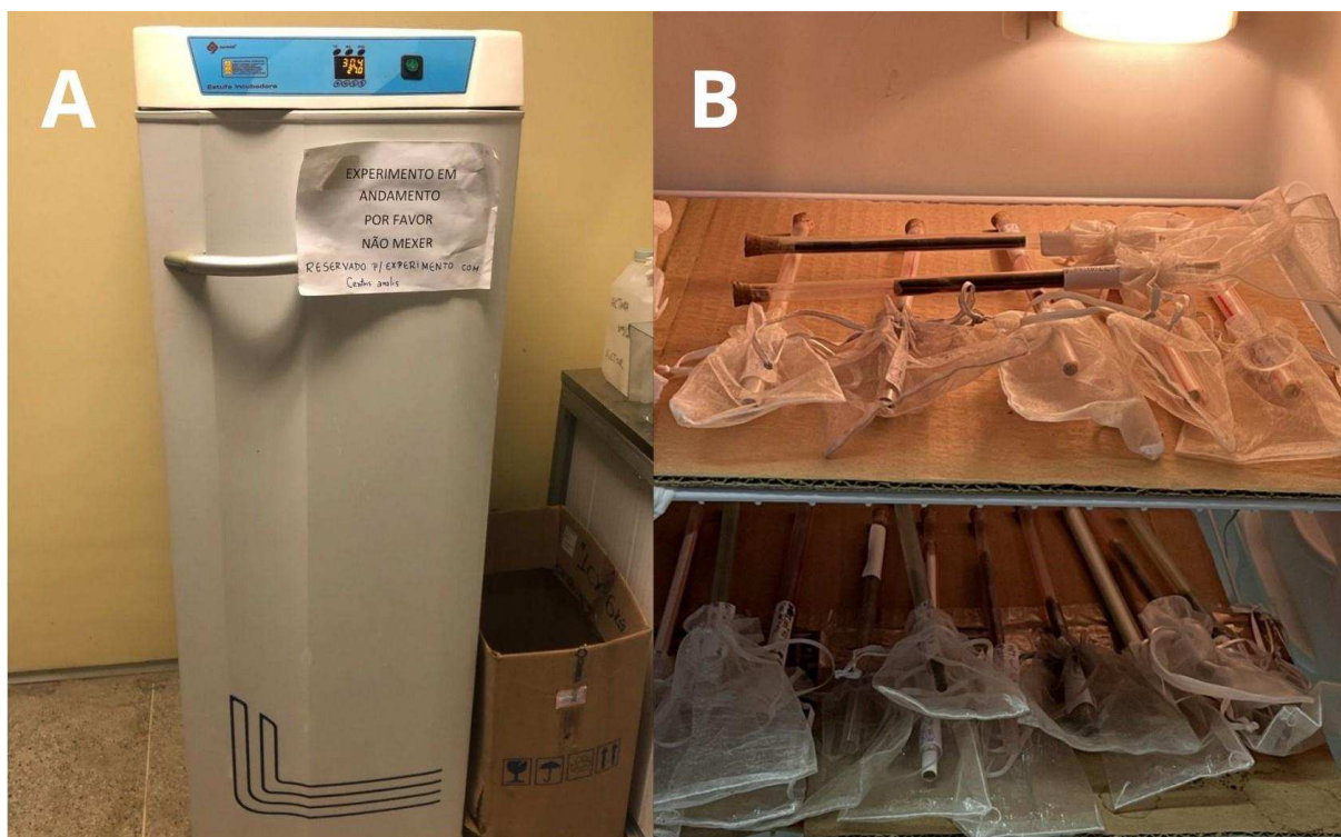
Figura 6 – Sítio de incubação para o acondicionamento de ninhos-armadilha operculados de abelhas solitárias da espécie Centris analis e incubadora do tipo Demanda Bioquímica de Oxigênio (Biochemical Oxygen Demand) denominada BOD [Vista externa (A) e vista interna (B)], que manteve os ninhos-armadilha sob controle de temperatura, a 27 °C. Este sítio de incubação foi utilizado de novembro de 2020 até março de 2024, no Setor de Abelhas do Departamento de Zootecnia da Universidade Federal do Ceará.
