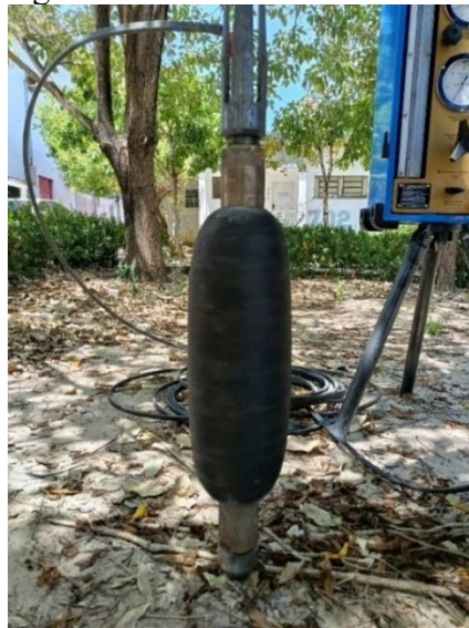
Figura 40 - Sonda inflada ao ar livre.
