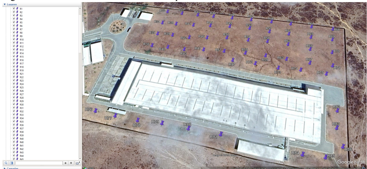
Figura 10 – Posicionamento das antenas receptoras
