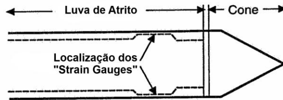
Figura 4 - Desenho esquemático do primeiro cone para medição de tensões laterais
