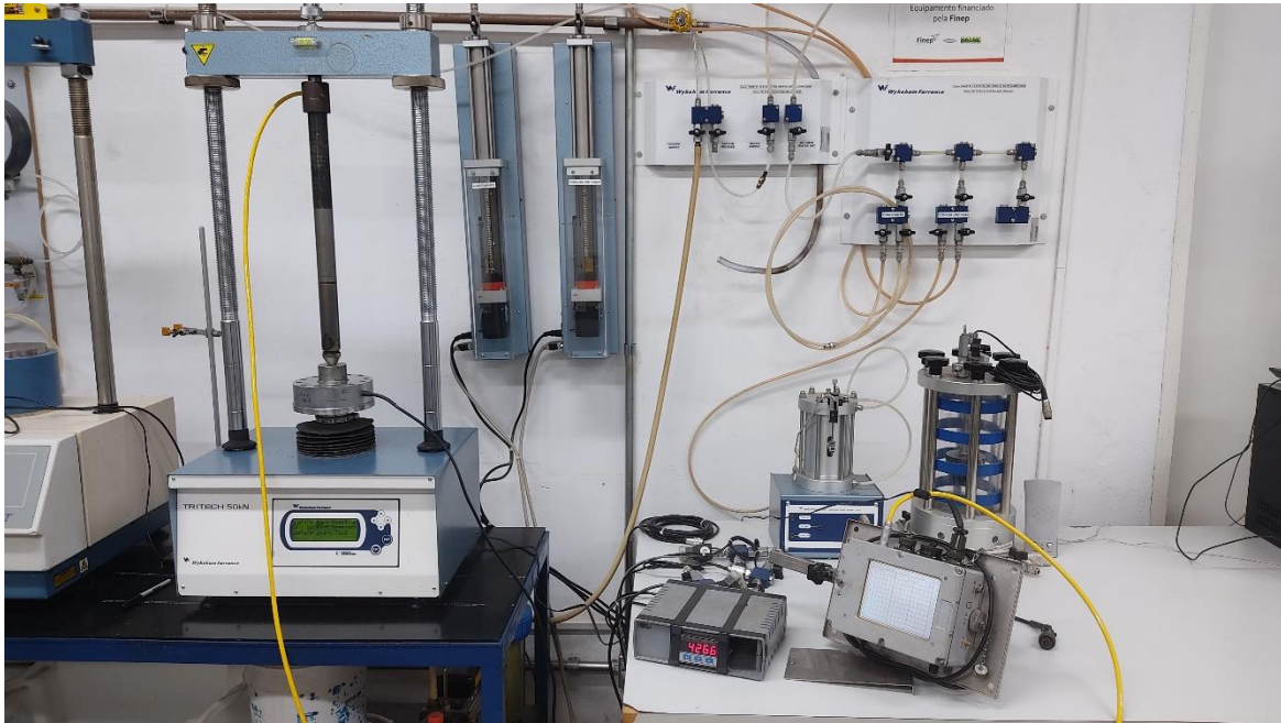
Foto 1 – Vista geral dos equipamentos utilizados para a realização do ensaio para calibração e checagem da célula de carga da ponta do piezocone.
