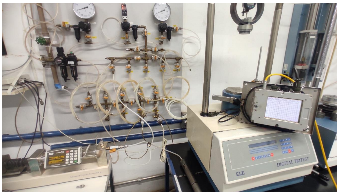
Foto 3 – Vista geral dos equipamentos utilizados para a realização de um ensaio para calibração e checagem do transdutor de poro-pressão de piezocones. Detalhe do sistema de medida e aplicação de pressão.
