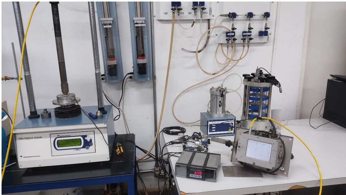
Foto 2 – Vista geral dos equipamentos utilizados para a realização do ensaio para calibração e checagem da célula de carga da luva de atrito do piezocone.
