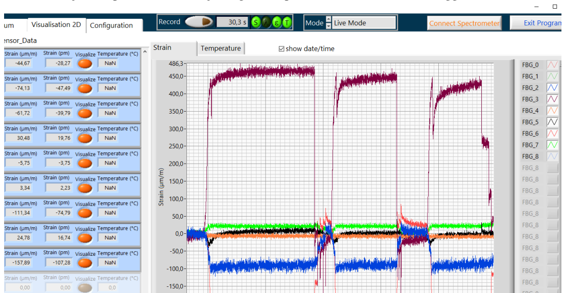
Figura 19 – Interface do software BraggSens 1.89 durante a aplicação de carga nos ensaios estáticos em laboratório, mostrando a variação temporal da deformação registrada por sensores de rede de Bragg.
