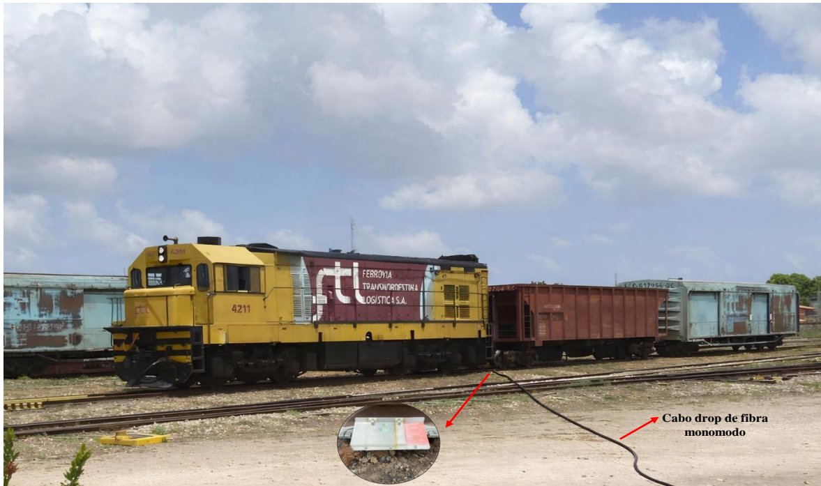
Figura 11 – Trem de carga utilizado nos testes de campo controlados, composto por uma locomotiva e dois vagões de carga com diferentes características de massa.
