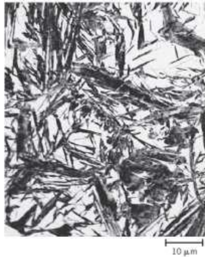
Figura 7: A microestrutura martensítica em ripas.
