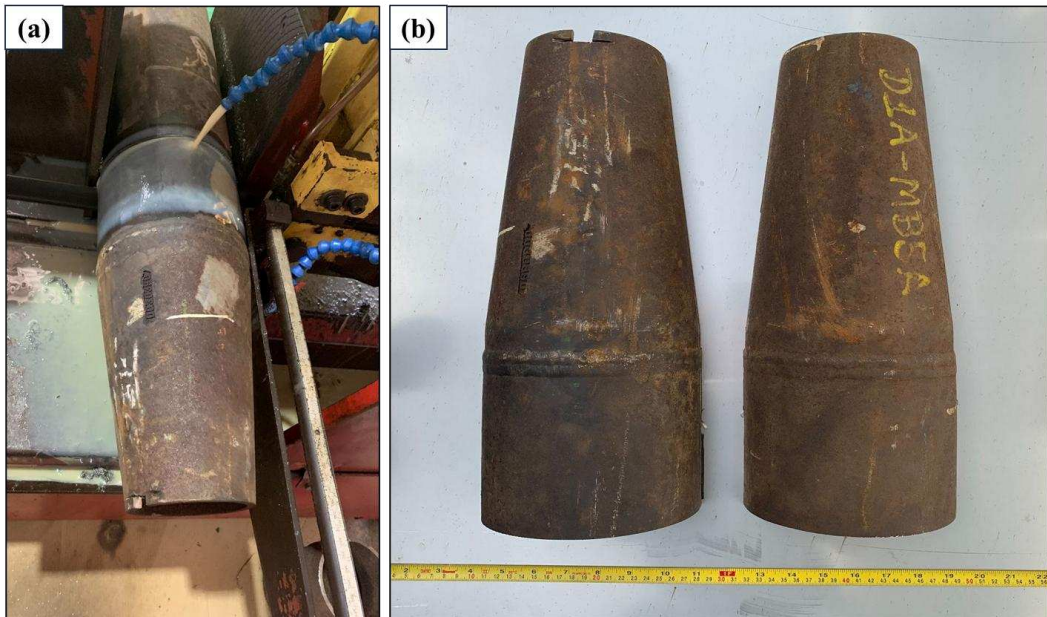
Figura 13 — (a) corte da lança do flare na serra fita (b) lança após o corte
