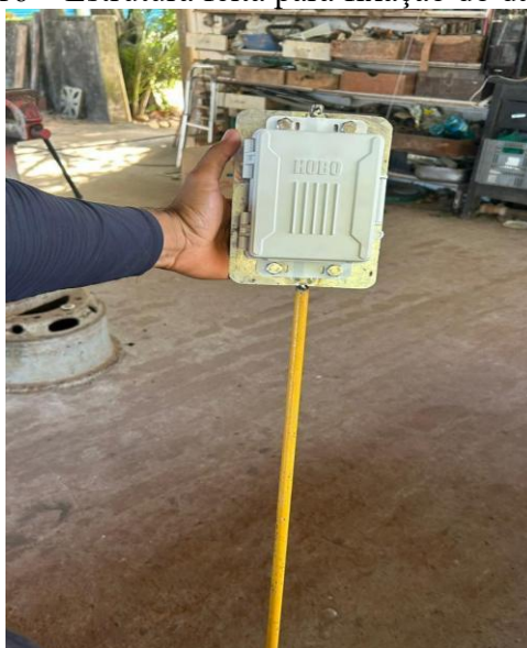
Figura 16 – Estrutura feita para fixação do datalogger
