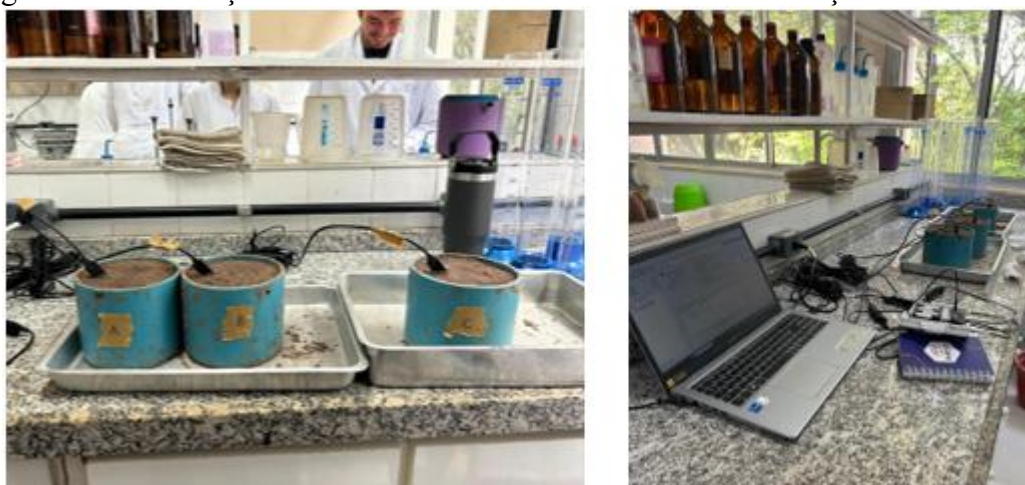
Figura 11 – Calibração dos sensores de umidade do solo sob condições de laboratório
