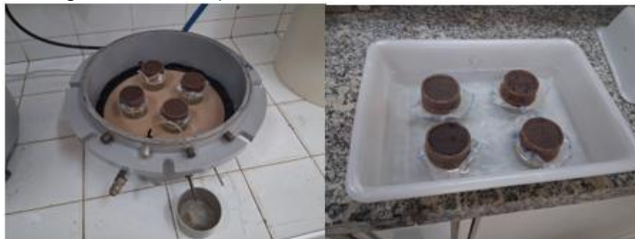
Figura 13 – Saturação das amostras e na câmara de Richards
