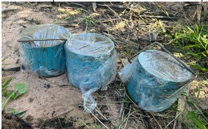
Figura 10 – Coleta das amostras indeformadas com tubos de PVC (DN100) para análise da acurácia dos sensores de temperatura e umidade do solo sob condições de laboratório
