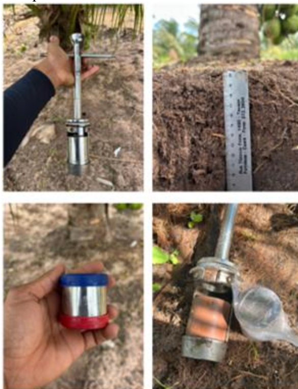
Figura 9 – Esquema de coletas de amostras indeformadas de solo
