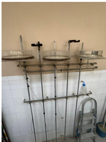
Figura 12 – Mesa de tensão para determinação da retenção de água no solo em diferentes tensões.
