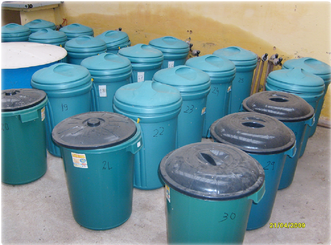
Figura 10 – Tambores utilizados para os testes de resistência ao cloro
