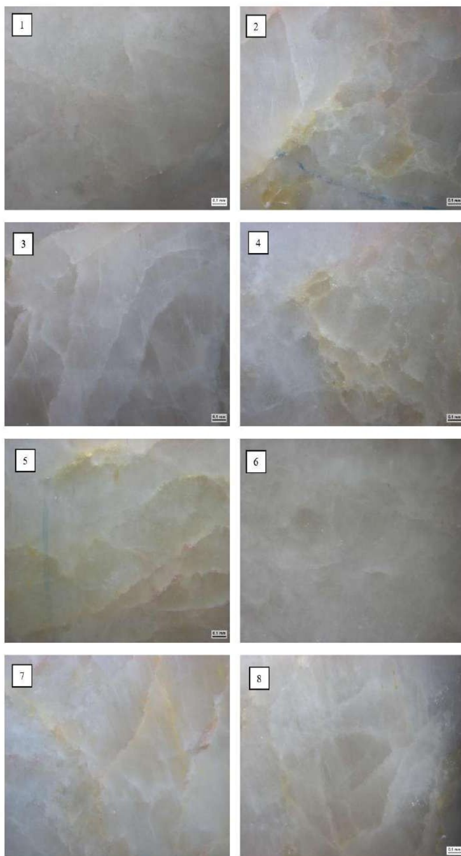
Figura 32 -3º Quadrante, Quartzito Perla Santana atacado com Ácido Clorídrico 18% (Escala: barra a esquerda das imagens = 0,1mm; largura de cada imagem=3,3cm).
