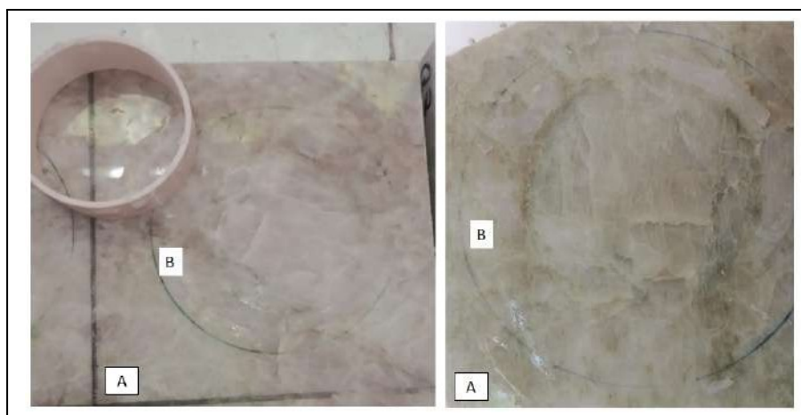
Figura 56-Experimento do ensaio de ataque químico com KOH 30% no quartzito taj mahal.
