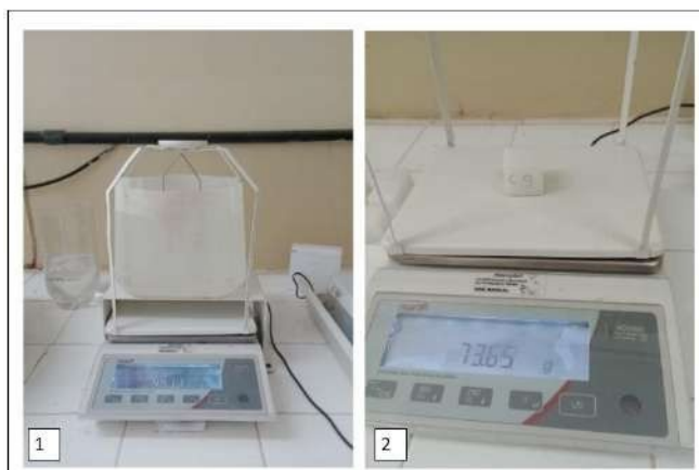
Figura 8- Procedimento de pesagem das massas submersas e saturada.
