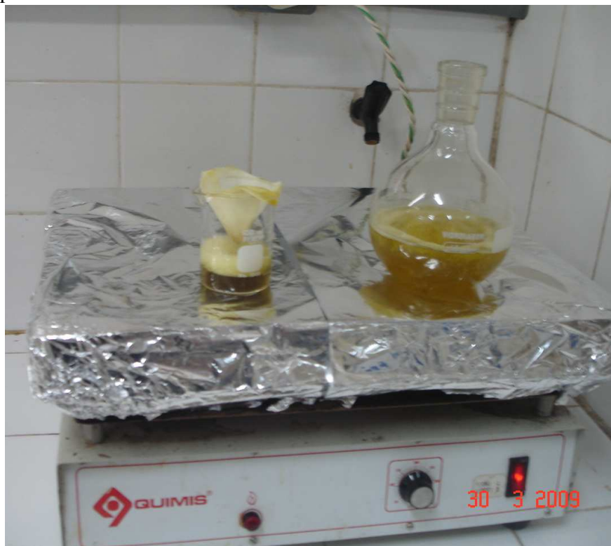
Figura 9 - Processo de evaporação de Nafta para obtenção de cera purificada.
