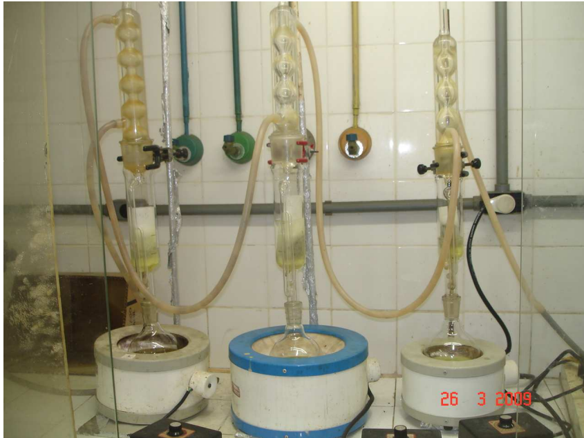
Figura 7 - Amostras de própolis em aparelhos Soxhlet para extração da cera.
