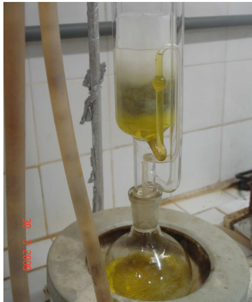
Figura 8 - Processo de extração de cera.
