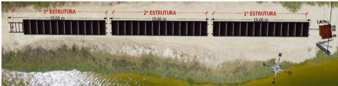
Figura 24- Alocação dos módulos no terreno
