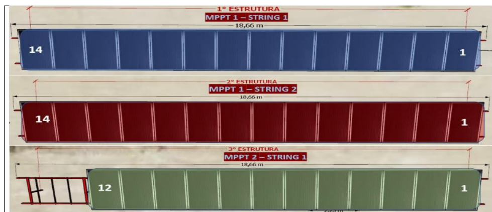
Figura 23 -Arranjo fotovoltaico conforme a divisão das strings
