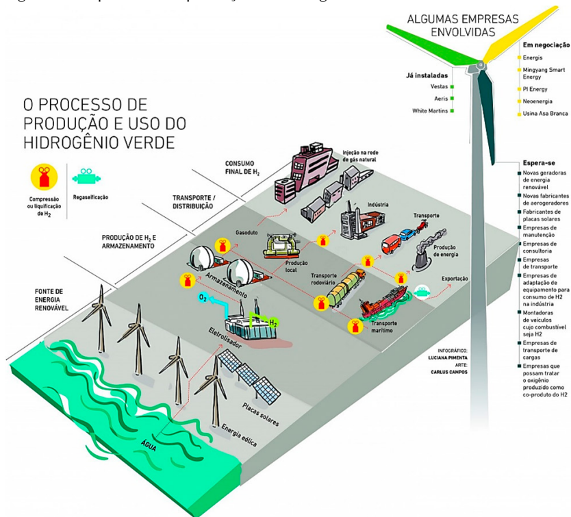
Figura 5 – O processo de produção do hidrogênio verde
