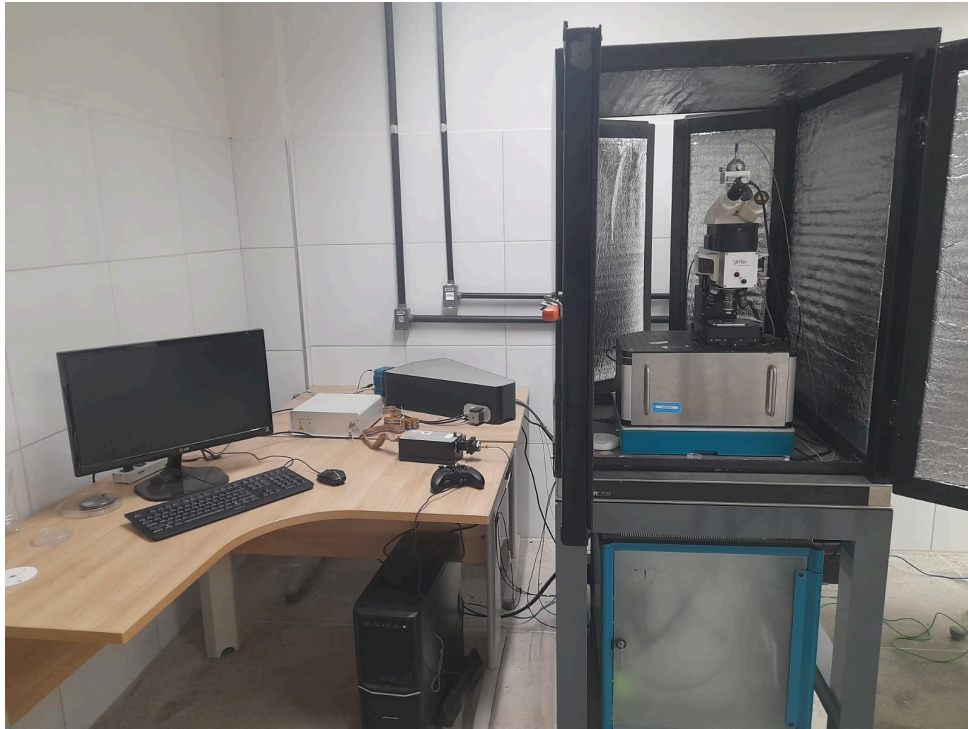
Figura 4: Espectrômetro Raman WITec Alpha 300R localizado no laboratório de espectroscopia vibracional da Universidade Federal do Ceará.
