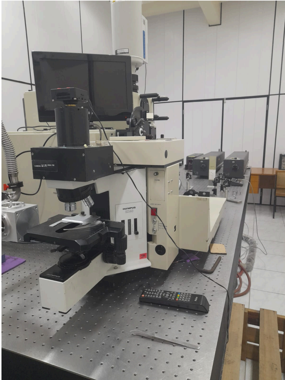
Figura 2: Espectrômetro T6400 localizado no laboratório de espectroscopia vibracional da Universidade Federal do Ceará.
