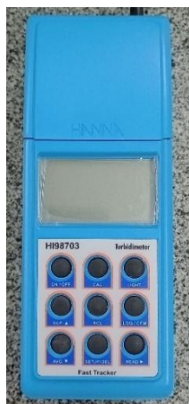
Figura 15 – Turbidímetro Hanna HI-98703
