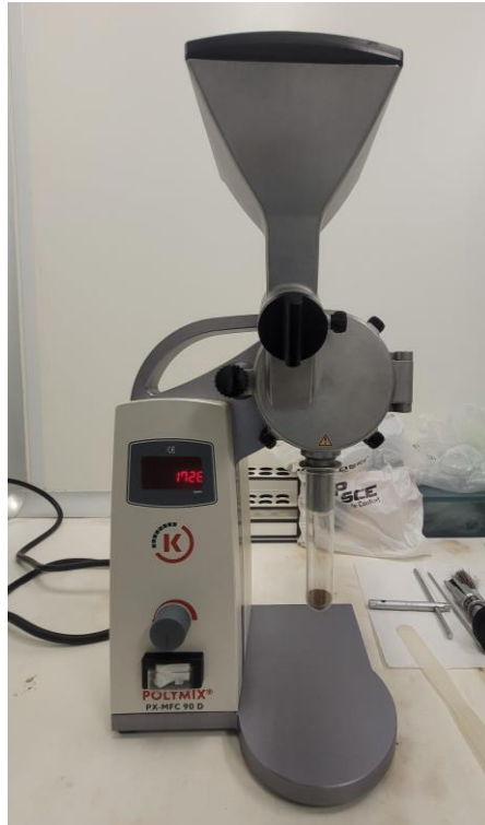
Figura 14 - Utilização do moinho para homogeneização das amostras.
