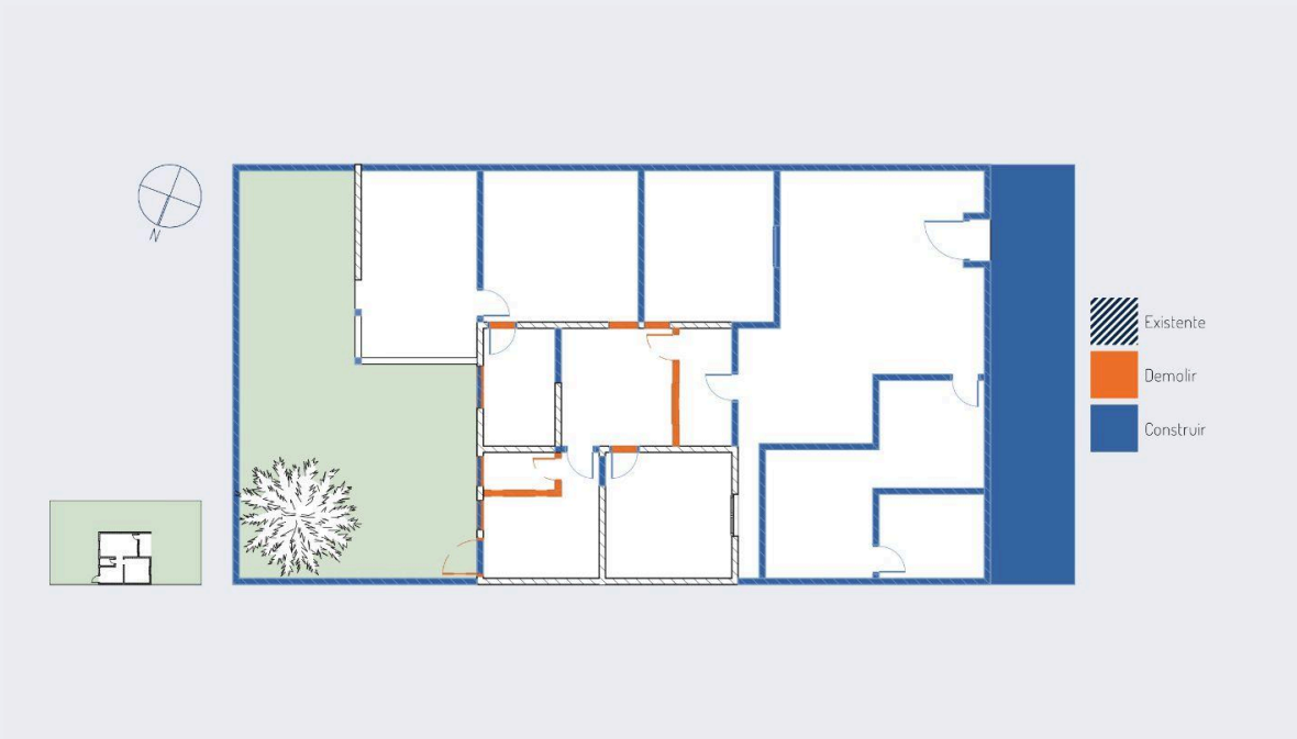
Figura 104 – Planta de Demolir/Construir da casa da Estênia, considerando a unidade entregue pela COHAB-CE
